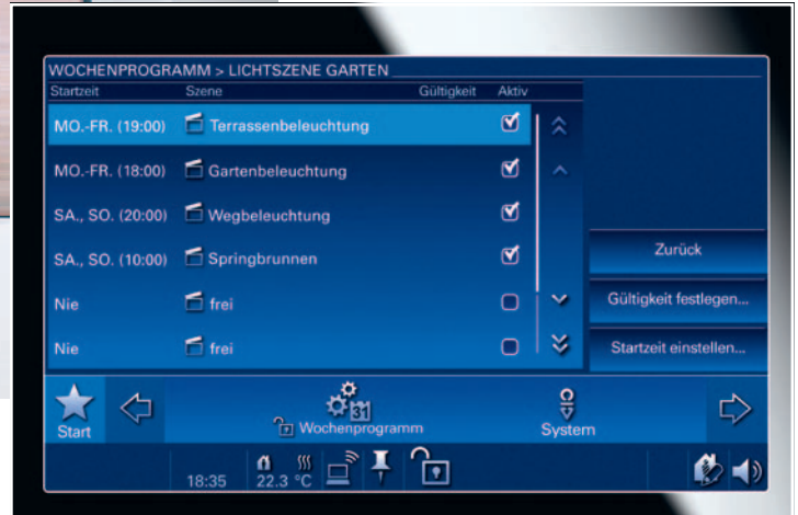
Bild oben: Die Gardena-Gartentechnik ist in die zentrale Bedienung der Gebäudesystemtechnik integriert und kann bequem von drinnen gesteuert werden.
